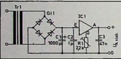
Bild 3: Festspannungsregler mit einstellbarer Ausgangsspannung
